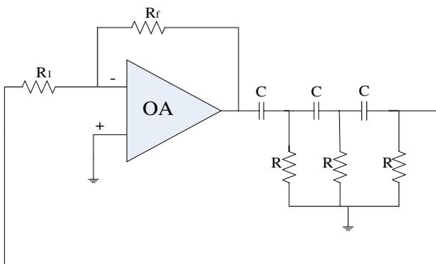
Fig. 4 Phase shift oscillator
