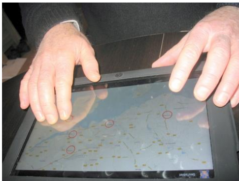
Fig. 4. Exploration d'une carte présentant 4 villes autour de Rennes. Lors du contact avec le doigt, les noms des villes sont annoncés vocalement et une vibration continue est déclenchée.
