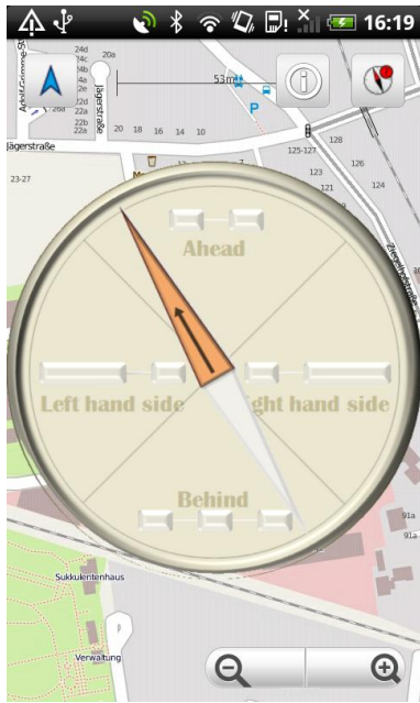
Fig 1. Pocket navigator. En cours de déplacement, les informations de guidage sont générées en fonction de la direction du point à atteindre conformément au cadran ci-dessus : 2 vibrations pour tout droit, 3 pour derrière, 1 longue et 1 courte pour tourner à gauche, 1 courte et une longue pour tourner à droite.
